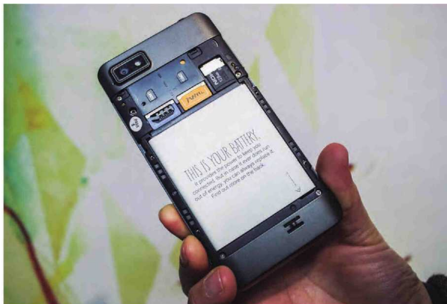
La bateria del Fairphone és extraïble i reemplaçable. Foto: Ricard Viladoms
